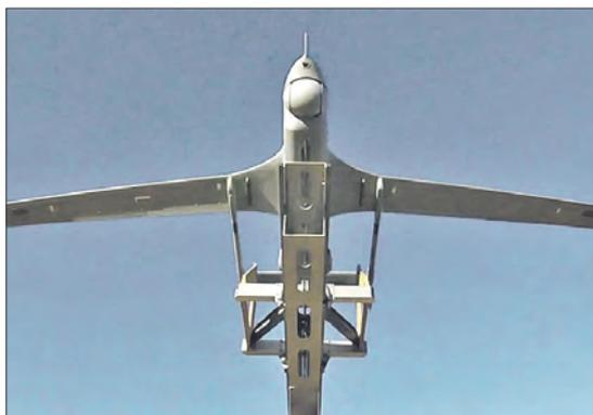
**Тактический разведывательный БПЛА RQ-21A «Блэк Джек»**
