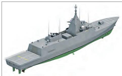
ледовой обстановки. Длина корабля 117 м, водоизмещение 4 300 т, экипаж 73 человека, автономность плавания 14 сут, осадка 5 м. Их поставка ожидается до 2029 года.
