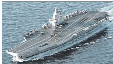
станут его ходовые испытания. Водоизмещение корабля превышает 80 000 т, длина летной палубы около 316 м. По утверждению экспертов, тестирование продлится около года, а передача ВМС НОАК следует ожидать в 2025 году.
