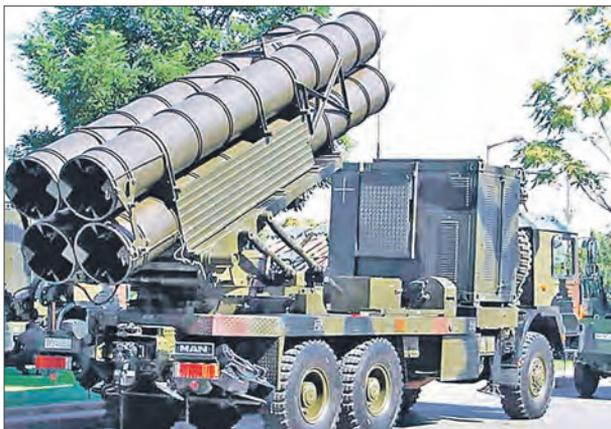
*Реактивная система залпового огня WS-1*
