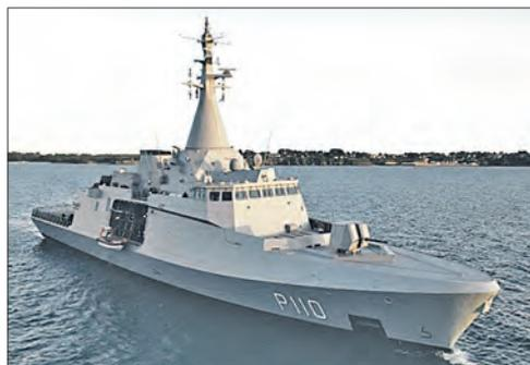
стоялся в мае 2022 года, проходит подготовку к морским испытаниям. Корвет этого класса имеет полное водоизмещение 2 800 т, длину 102 м, ширину 16 м, максимальную скорость хода 25,5 уз, автономность 21 сут. Он способен разместить вертолет массой 10 т, беспилотный летательный аппарат и две надувные шлюпки с жестким корпусом длиной 2,7 м.
